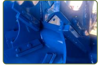
Valsarna skyddas av smatterkoppling
