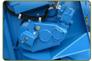
Hydrauliskt driven reversibel bottenmatta
