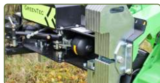
AHS hydraulisk påkörningssäkring med 45° redskapsretur, optimerar arbetet och säkrar maskinen från överbelastning. Motvikt, 50 kg (extrautrustning).
