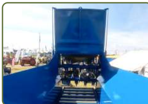
Dubbelverkande hydraulisk giljotindörr
