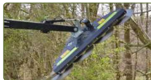
Grensåg LRS monterad. Hydraulisk klippvinkejustering 110° (extrautrustning PUMA 3303). Kräver 1 st dubbelverkande hydrauluttag.
