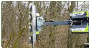
Grensåg LRS monterad, extrautrustad med motviker.
