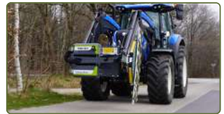
Trafiksäkerhet - Vid transport fäller man ihop PUMA 2803, så bredden minskar.
