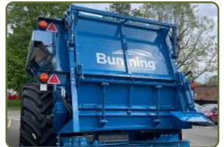
Hydraulisk öppningsbar baklucka
