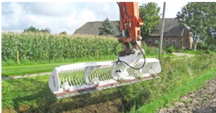
Med en klippskopa kan vass och annan vegetation tas bort utan att dikets botten påverkas. Foto: YstaMaskiner AB
