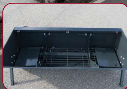
Öppningsbara skyddsgaller och spidarregleringsplåtar
