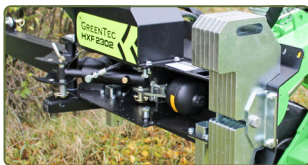
AHS hydraulisk påkörningssäkring med 45° redskapsretur, optimerar arbetet och säkrar maskinen från överbelastning. Motvikter, 55 kg (extrautrustning).
