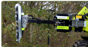
Grensåg LRS monterad, extrautrustad med motviker.
