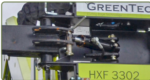
AHS hydraulisk påkörningsssäkring med redskapsretur, detta optimerar arbetet och säkrar maskinen från överbelastning (standardutrustning).
