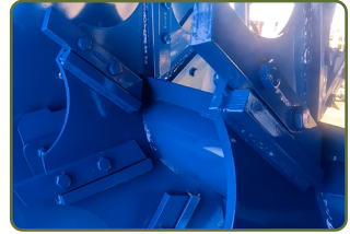
Valsarna skyddas av smatterkoppling
