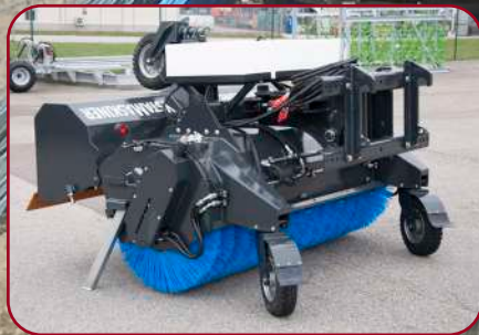
Stabila runtomsvängande massiva stödhjul och uppfälld uppsamlingsbox
