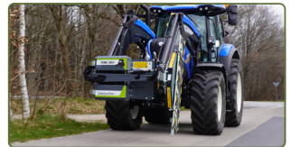
Trafiksäkerhet - Vid transport fäller man ihop PUMA 2803, så bredden minskar.
