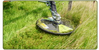
Kant-/Stolpklippare RI monterad.
