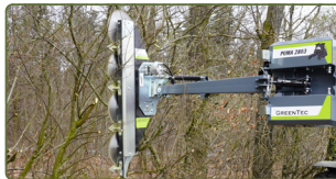
Grensåg LRS monterad, extrautrustad med motvikter.
