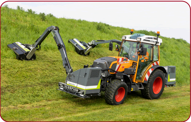
Möjlighet att montera både fram och bak på traktorn
