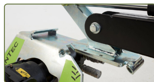
Mekanisk snabbkoppling (standard) och hydraulisk klippvinkeljustering (extrautrustning PUMA 2303). Kräver 1 dubbelverkande hydrauluttag.
