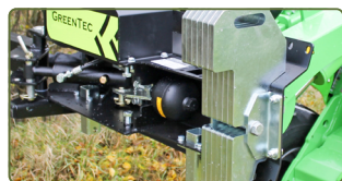
AHS hydraulisk påkörningssäkring med 45° redskapsretur, optimerar arbetet och säkrar maskinen från överbelastning. Motvikter, 50 kg (extrautrustning).
