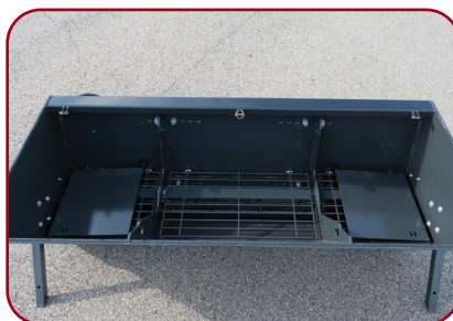
Öppningsbara skyddsgaller och spidarregleringsplåtar
